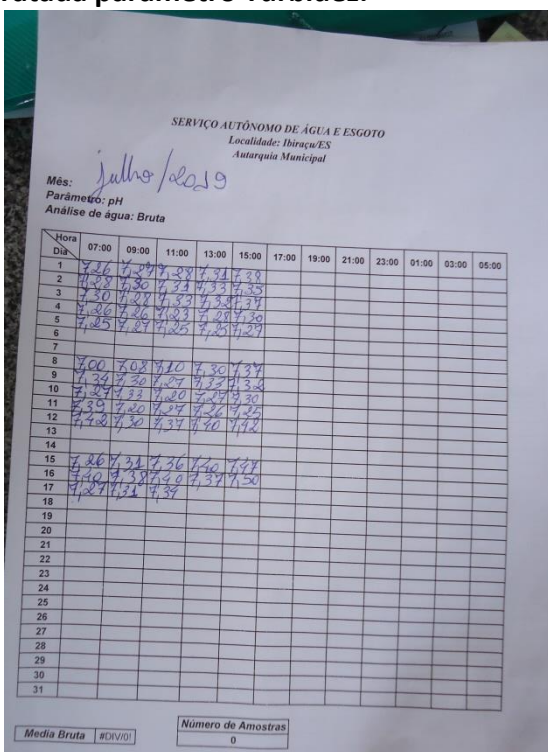
Figura 67 – Registro qualidade da água Bruta parâmetro pH.
