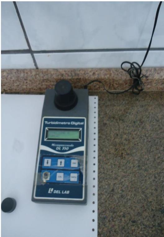
**Figura 58 -Equipamentos para ensaios Físicos-Químicos Turbidímetro.**
