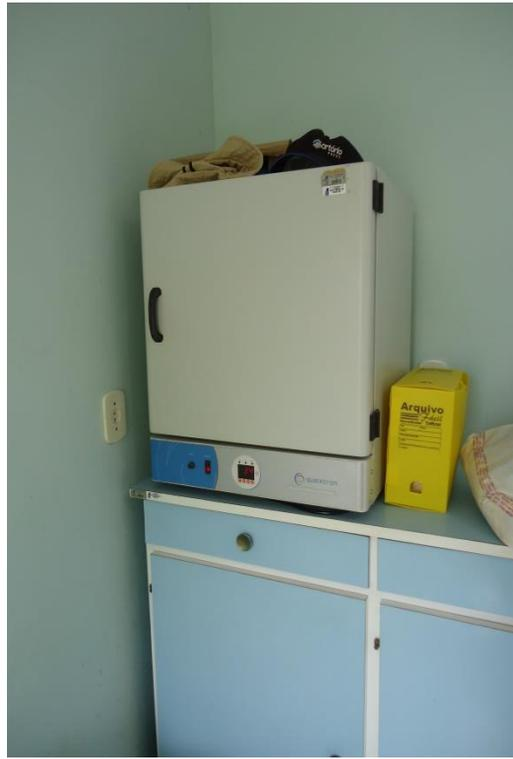
**Figura 57 -Equipamentos para ensaios Físicos-Químicos Estufa.**
